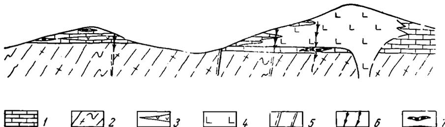
Рис. 5. Разрез через золоторудное месторождение Лебединое (по А. И. Фасталовичу и Н. В. Петровской). Кембрийские карбонатные породы (1), архейские граниты и гнейсы (2), мезозойские пластовые интрузивы (3), мезозойские сенилпорфиры (4), разрывные нарушения (5), золоторудные жилы (6), пологие золоторудные залежи (7)
